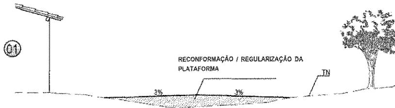
AS OBRAS DE TERRAPLENAGEM, DE DRENAGEM, DE REGULARIZAÇÃO E ESTABILIZAÇÃO DA CAMADA QUE SERVIRÁ DE BASE DO CALÇAMENTO OU RECONFORMAÇÃO DA PLATAFORMA DEVERÃO ESTAR CONCLUÍDAS.
