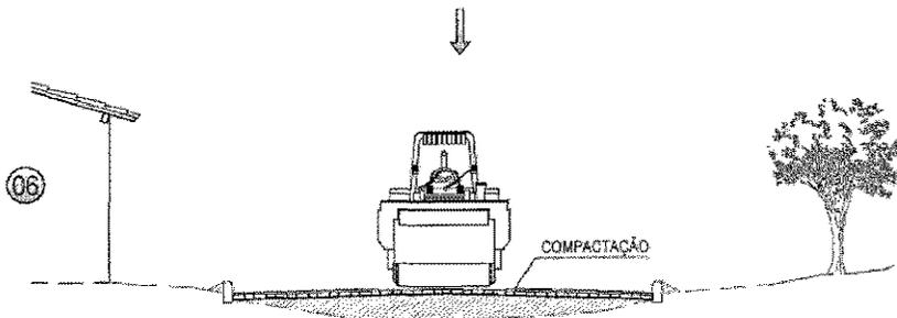
AS PEDRAS SOB A CAMADA DE AREIA DEVERM SER BATIDAS INICIALMENTE COM COMPACTADOR MANUAL TIPO PLACA VIBRATÓRIA E EM SEQUIDA PASSA-SE O ROLO COMPRESSOR, COMEÇANDO PELO PONTO DE MENOR COTA PARA O DE MAIOR COTA NA SEÇÃO TRANSVERSAL. O NÚMERO DE PASSADAS, ASSIM EXECUTADAS, É DE 3 VEZES NO MÍNIMO.
