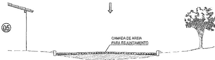
ANTES DA COMPRESSÃO COM O ROLO METÁLICO, JOGA-SE AREIA SOBRE O CALÇAMENTO, NA QUANTIDADE SUFICIENTE PARA PREENCHER AS JUNTAS E FORMAR UMA CAMADA SOBRE O CALÇAMENTO DE APROXIMADAMENTE 2CM.
