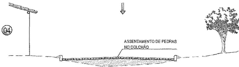
OS BLOCOS DE PEDRA TOSCAS SERÃO ASSENTES SOBRE O COLCHÃO DE AREIA EM LINHAS PERPENDICULARES AO EIXO DA PISTA, OBEDECENDO AS COTAS E ABaulamentos DO PROJETO. EM TANGENTE, O ABaulAMENTO SERÁ FEITO POR DUAS RAMPAS, OPOSTAS A PARTIR DO EIXO, COM DECLIVIDADE DE 3% SALVO OUTRA INDICAÇÃO DO PROJETO. NAS CURVAS, A DECLIVIDADE TRANSVERSAL SERÁ A INDICADA PELA SUPER-ELEVAÇÃO PROJETADA
